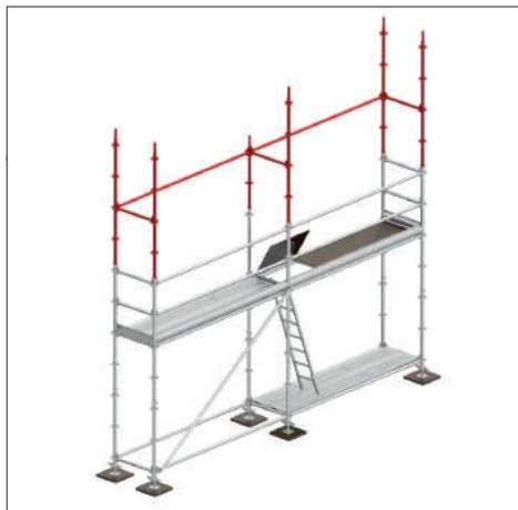
11 Mettre en place les planchers ainsi que les moyens d'accès (plancher à trappe) en quinconce.
