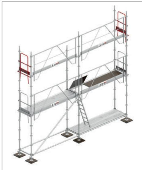
12 Positionner les longerons intérieurs (côté façade), puis les traverses (longerons) servant de support plancher.
